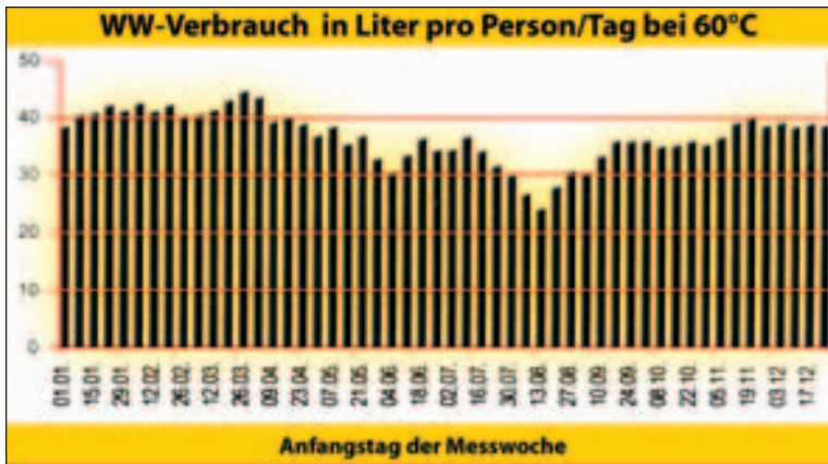
Abb. 3.2.14 typisches Profil des Warmwasserjahresverbrauchs in Liter pro Person und Tag bei 60 °C eines Mehrfamilienhauses; Grafik: ASiC; Quelle: [8]
