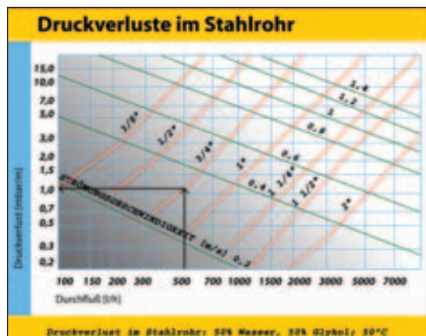
Abb. 5.9 Druckverlust in Stahlrohren; Grafik: ASIc; Quelle: [2]
