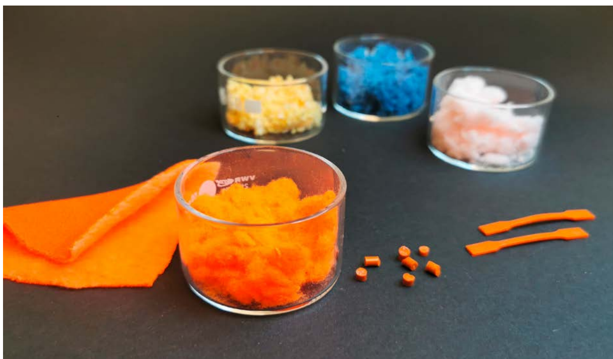
→ Verschiedene Textilabfälle (Fasern) und daraus recyceltes Material (Granulat, Prüfkörper) © TCKT
