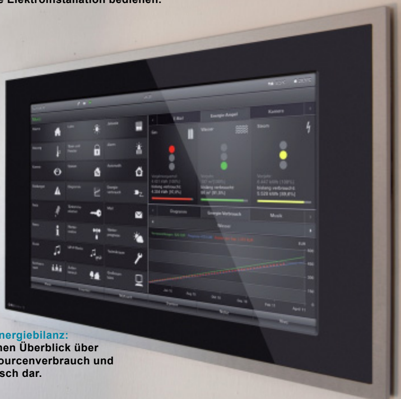
Info-Terminals: Über Touchscreens lässt sich die gesamte Elektroinstallation bedienen.
