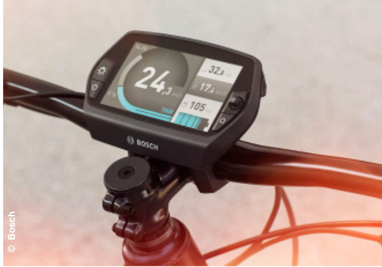
E-Bikes: Neben der Ansteuerung des Antriebs braucht es Ladeelektronik für den Akku und einen Info-Bildschirm. Das sind Embedded Systems im E-Bike.
